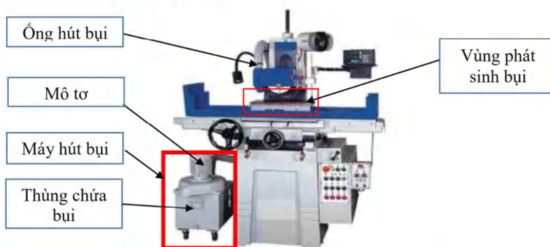
Hình 4. 12. Máy hút bụi đi kèm máy mài kim loại.
