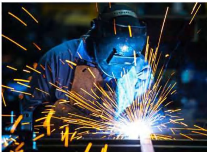
Hình 4. 4. Minh họa trang bị đầy đủ mặt nạ khi thực hiện hàn cắt.
