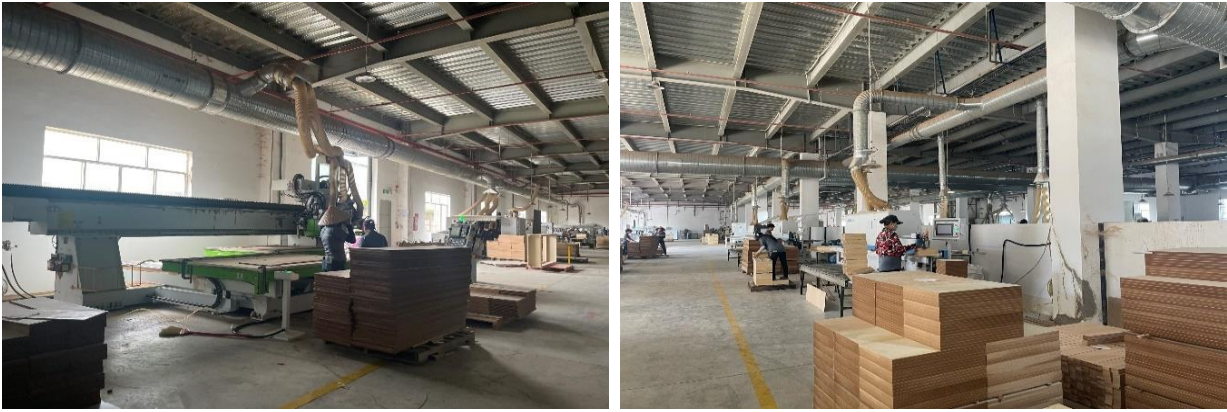
Hình 4.6 Hệ thống thu gom và xử lý bụi bằng Cyclon
