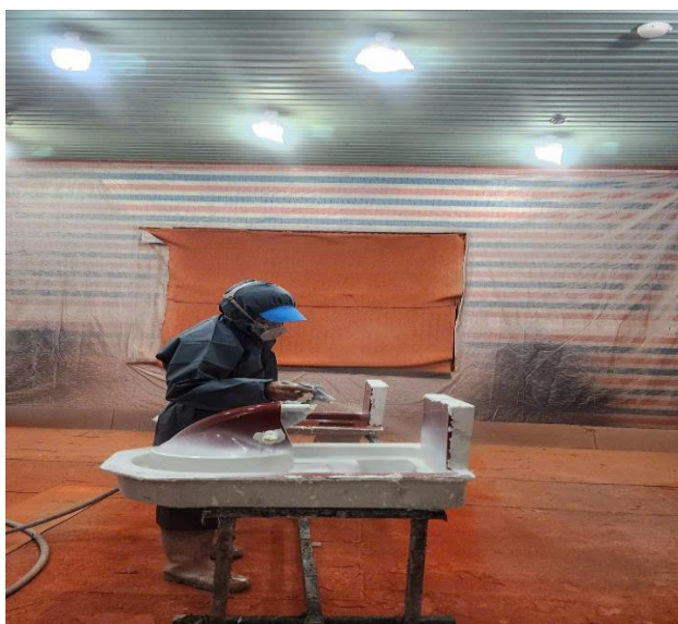
Bước 1: Phủ chất đánh bóng, gelcoat lên bề mặt khuôn (Phòng sơn thực hiện quá trình phun gelcoat)
