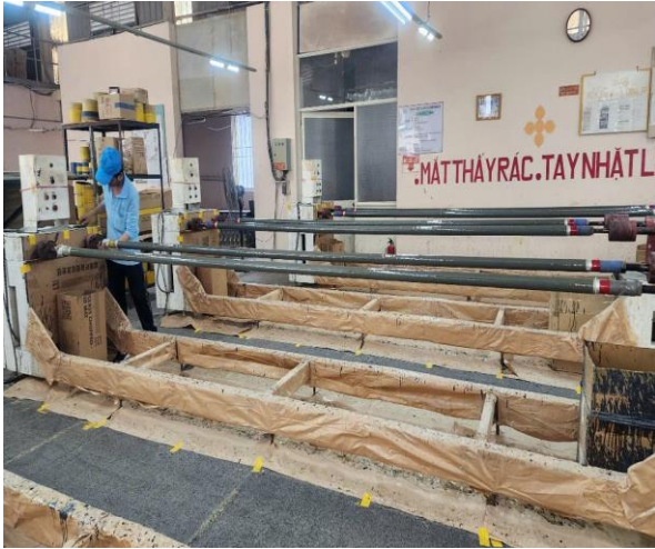
Bước 2: Tạo hình bằng gia cố thêm Composite lên PVC có sẵn
