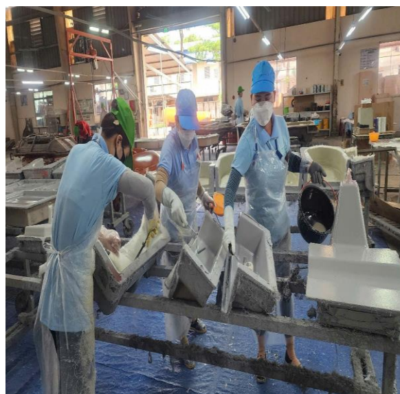
Bước 2: Tạo hình (Đắp sợi thủy tinh và keo composite lên khuôn mẫu bằng phương pháp thủ công)
