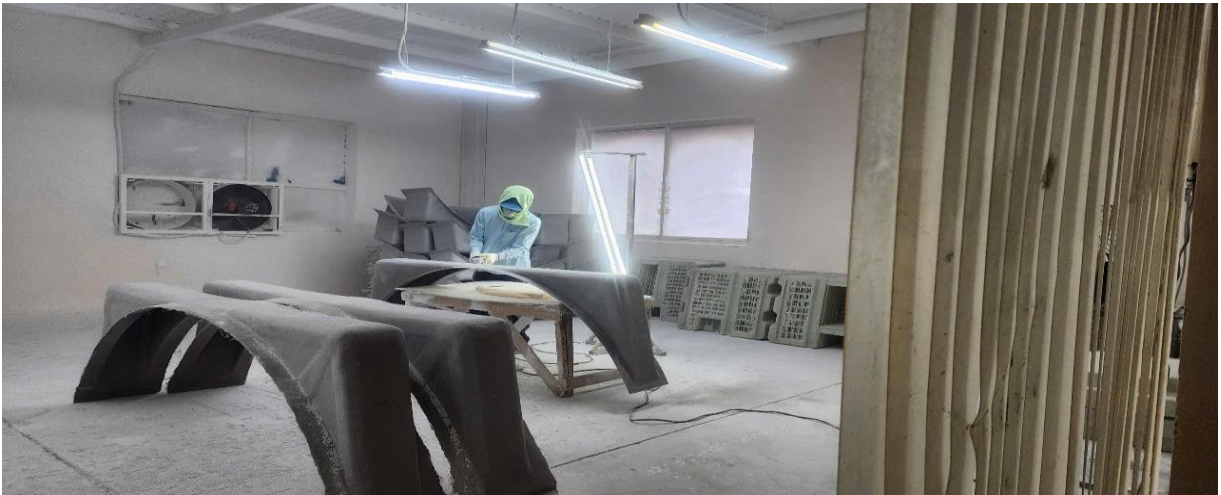
Bước 3: Cắt viên và hoàn thiện sản phẩm (Công đoạn cắt, gọt mài) Hình 4. Một số hình ảnh trong quy trình sản xuất vật liệu composite và khuôn mẫu bằng composite.
