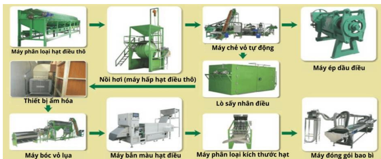
Hình 1: Các thiết bị trong dây chuyền sản xuất nhân điều [2]
