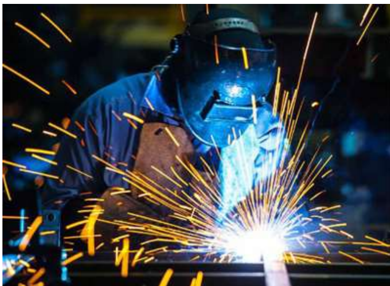
Hình 4. 3. Minh họa trang bị đầy đủ mặt nạ khi thực hiện hàn cắt.
