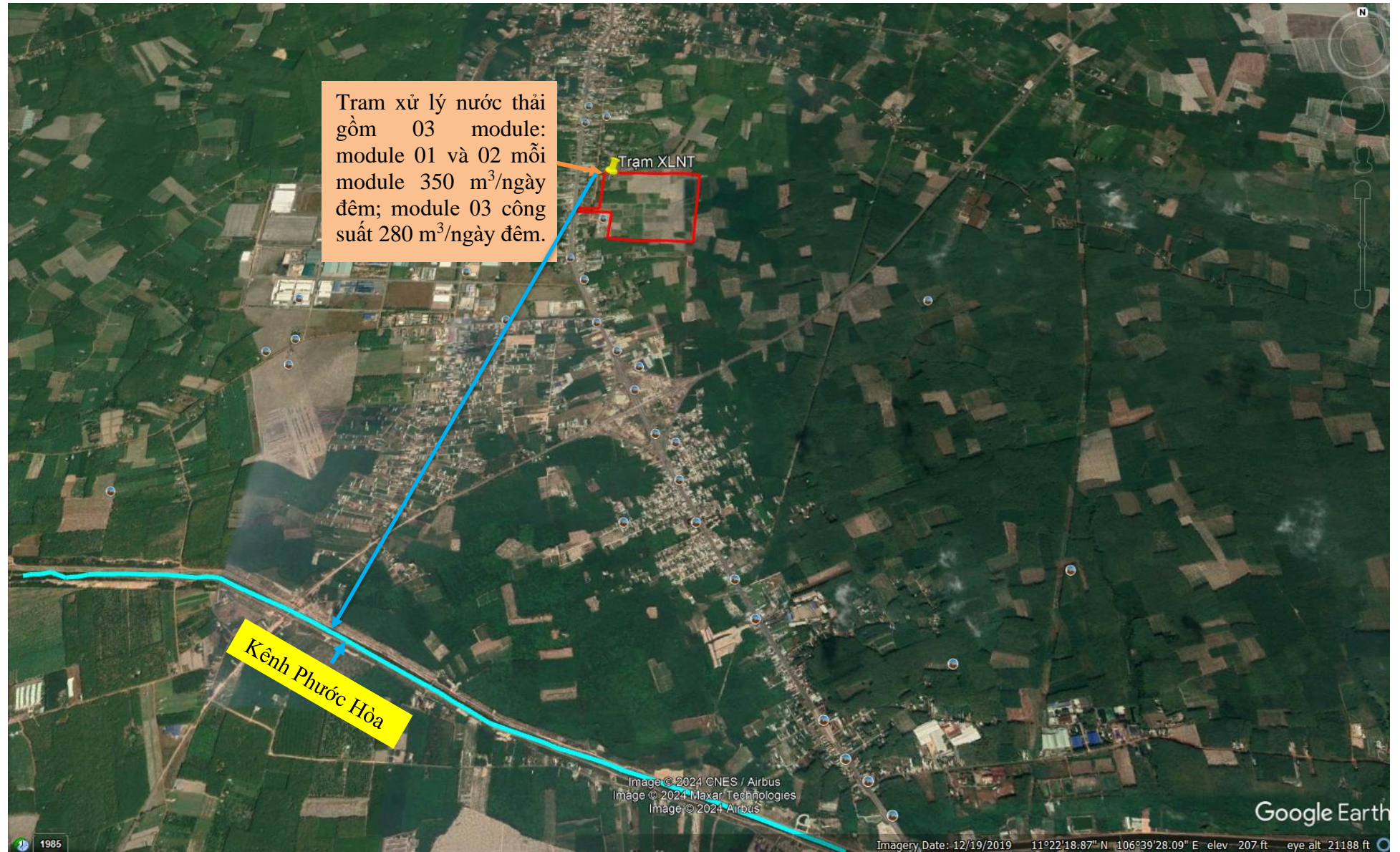
Hình 3.2. Sơ đồ tuyến thoát nước thải
